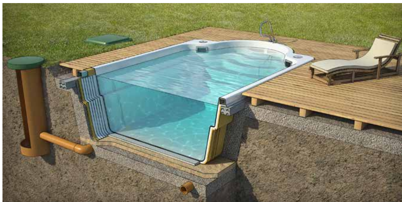
Installation av Luxe Pool glasfiberpool i genomskärning. En Luxepool läggs på en bädd av makadam. Corals pooler på en bädd av frigolit.
